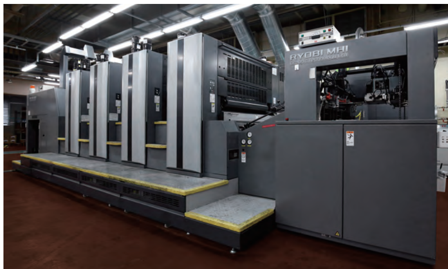
LED-UV 乾燥装置搭載 菊全判オフセット印刷機 V3000LS-4
